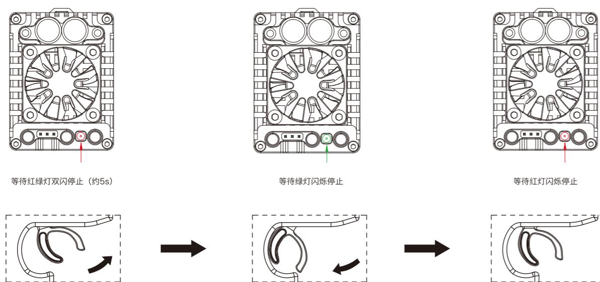
1. 电调关机 -> 正方向、油门和刹车调到100%行程->扳机打到“刹车推满”的位置并保持-> 上电 -> 等待红绿灯双闪停止(约5s)。
