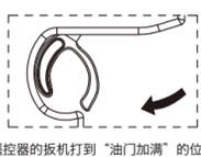
遥控器的扳机打到“油门加满”的位置
