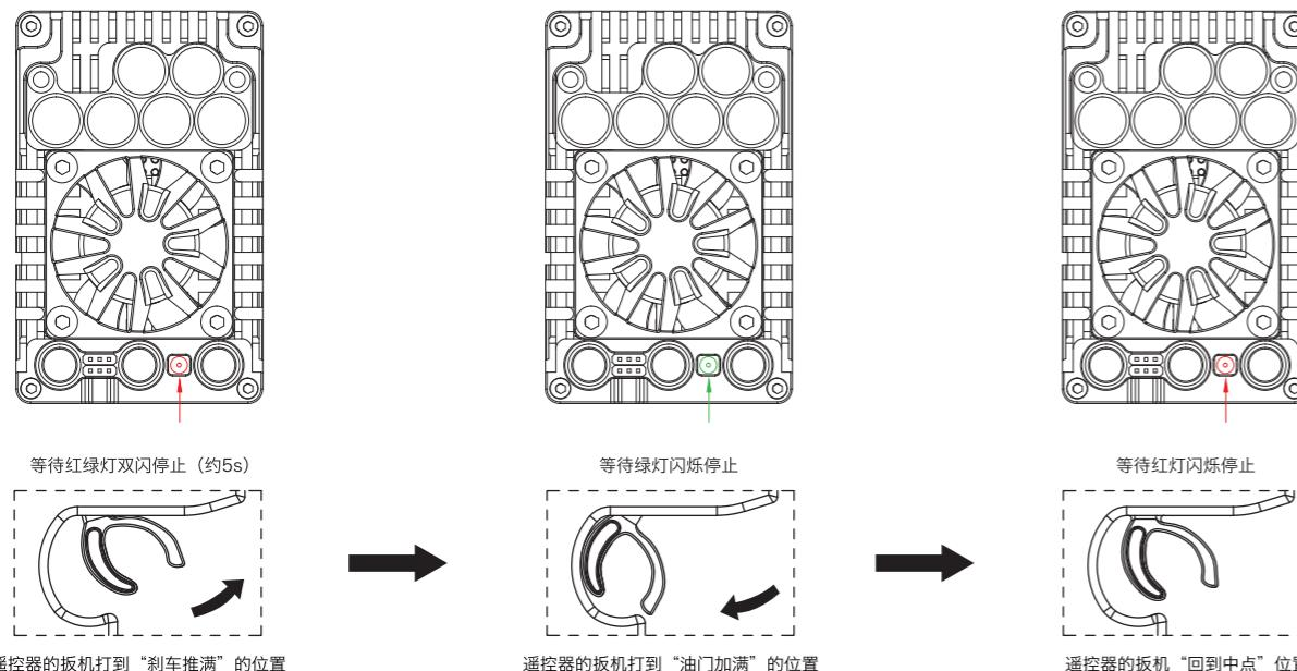
1. 电调关机 -> 正方向，油门和刹车调到100%行程 -> 报机打到“刹车推满”的位置并保持 -> 上电 -> 等待红绿灯双闪停止(约5s)。
